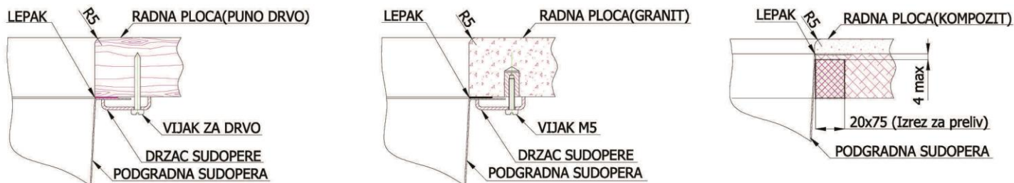
Crtež 1. (Skica namontirane podgradne sudopere na radnim pločama od drveta, granita I kompozita)
